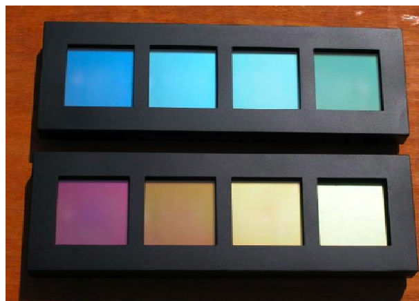
Figure 3 : Nouvelles couleurs de vitrages réalisées par l'équipement d'évaporation sous vide (Photo: Leso)
