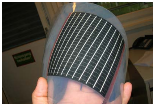
Figure 4: Module de démonstration avec des cellules CIGS flexibles (Source: FLISOM)
