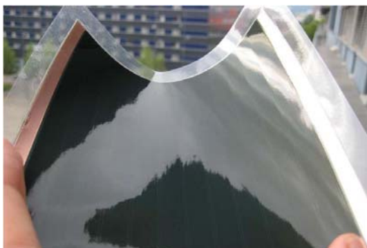
Figure 3: Prototype d'un module solaire à cellules CIGS (Source: ETHZ)
