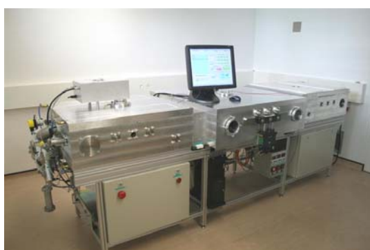
Figure 1: Installation automatisée de dépôt du silicium en couches minces, à chambre double, basée sur la KAI-M plasma box d'oerlikon solar (Source: IMT)
