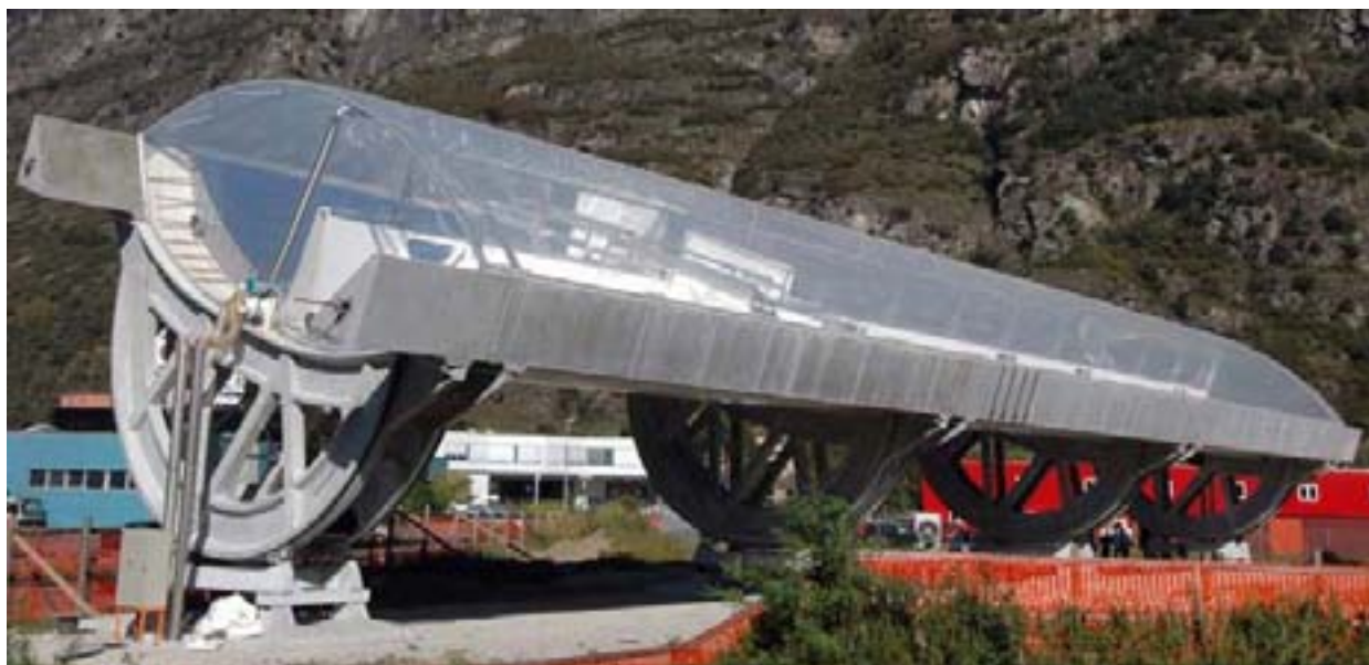
Figure 5: Troisième prototype du concentrateur Airlight mis en fonction à Biasca TI [4].
