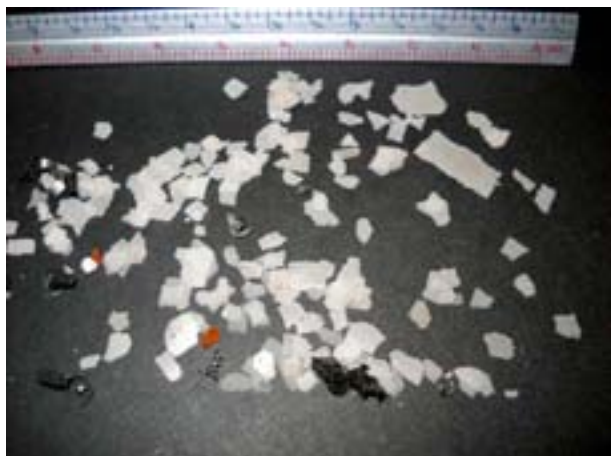
Figur 2: Ablagerungen («Kalkplättchen») aus der Tiefen-sonde Oftringen (Quelle: Oliver Sachs, Eberhard & Partner AG)
