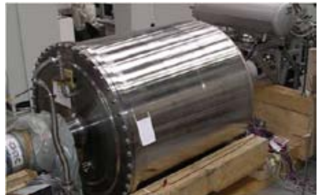
Figur 2: Rotor eines neuartigen 4000-kW-HTSL-Schiffsmotors (Quelle: Siemens).
