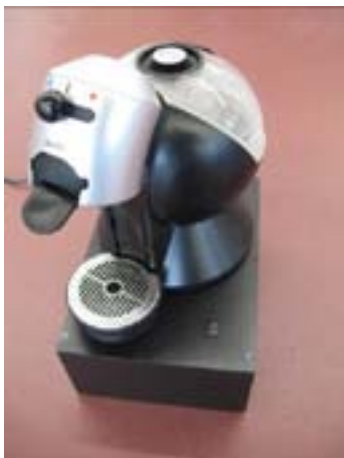
Figur 8: Funktionsmuster einer Kaffeemaschine mit Vakuumisolation (Quelle: Helbling Technik AG).
