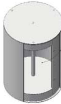
Figur 9: Skizze eines zylindrischen, vakuumisolierten Kühlschranks (Quelle: Helbling Technik AG).
