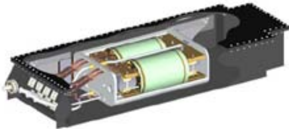
Figur 1: HTSL-Bahntransformator mit einer Wirkungsgradverbesserung von 92 % auf über 99 % (Quelle: Siemens).
